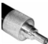
Для проведения измерения твердости на плоских поверхностях шайбу на насадке преобразователя необходимо установить плоской стороной к поверхности изделия, а для проведения измерения твердости на цилиндрических поверхностях шайбу на насадке преобразователя необходимо установить стороной с призматическими пазами к изделию.
