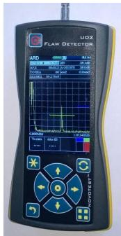
Ультразвуковой дефектоскоп УД2301 предназначен для проведения неразрушающего контроля качества металлов, пластиков, стекла, композиционных материалов, контроля сварных швов и измерения толщины различных изделий и конструкций.
